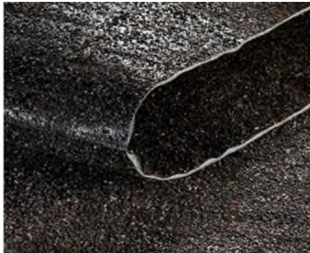
*Figura 53 - Geocomposito bentonitico NaBento RL-C*
