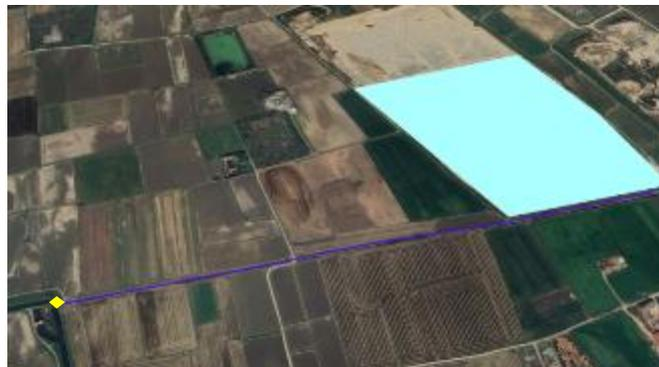
Figura 311 - Derivazione superficiale dal Diramatore Vigevano e ubicazione su ortofoto (il rombo in giallo indica il punto di derivazione)
