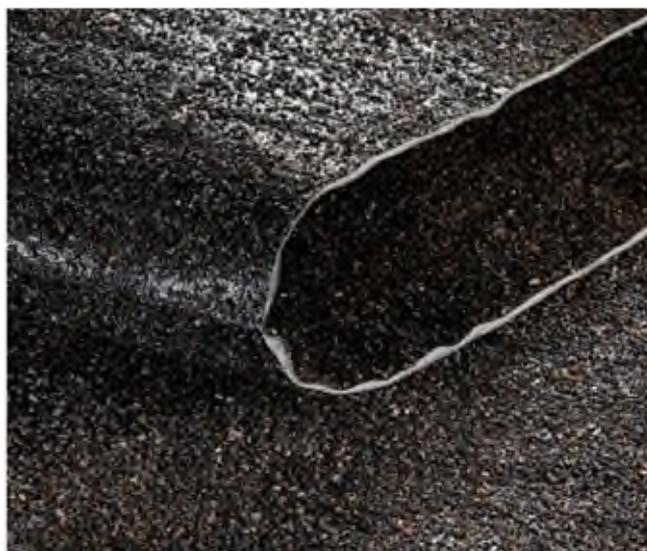
*Figura 11 - Geocomposito bentonitico NaBento RL-C*
