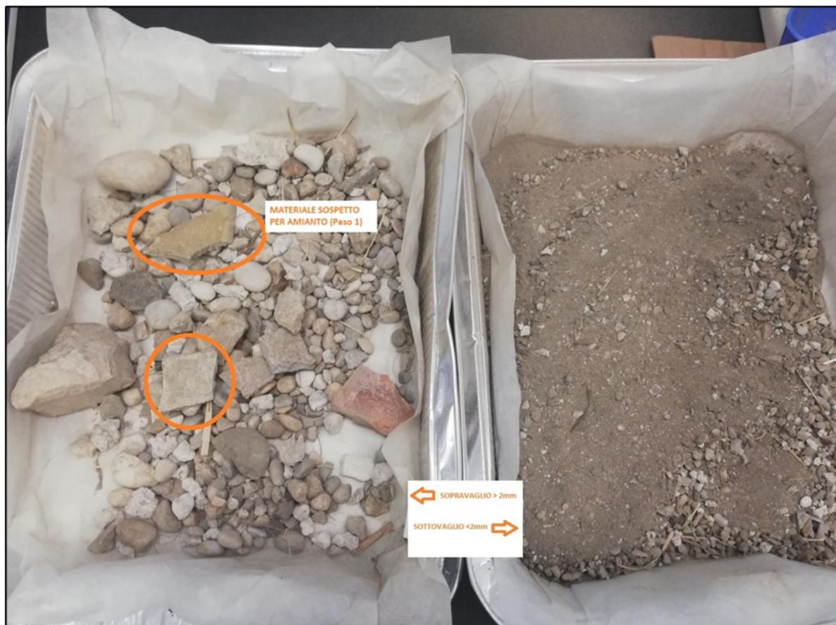
Qualora nella frazione superiore ai 2mm si identifichino ulteriori frammenti di MCA questi andranno uniti al materiale precedentemente isolato (**Peso1**) e pesati al fine di ottenere il peso totale del materiale contenente amianto della porzione del sopravaglio (→ **Peso 1b**).
